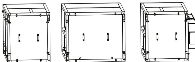
Avant de monter l'unité, connectez les sections et fixez-les avec des connexions à vis.
